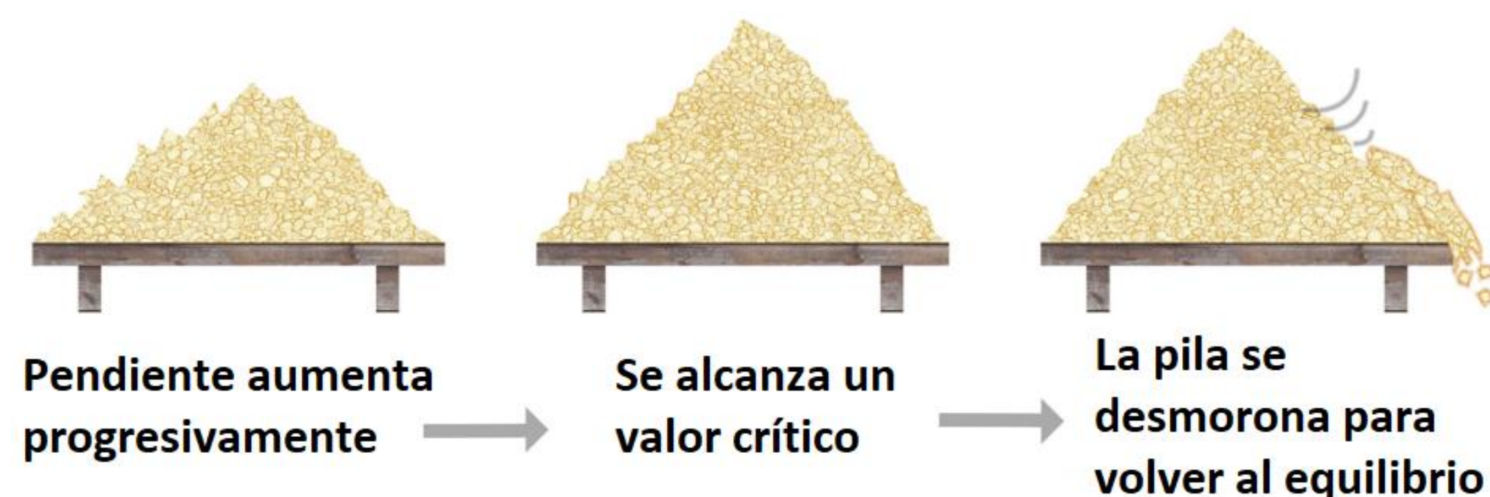
Fig. 2.- Modelo de pila de arena: el cono puede crecer tanto como sus propiedades internas le permitan soportar su propio peso.
